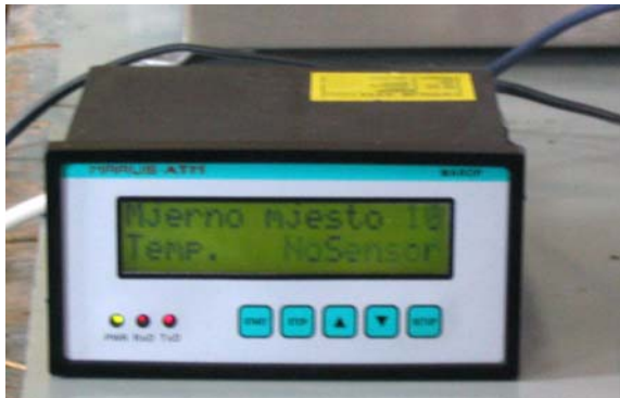
Slika 5 mjerni sustav s direktnim prikazom izmjerene temperature
